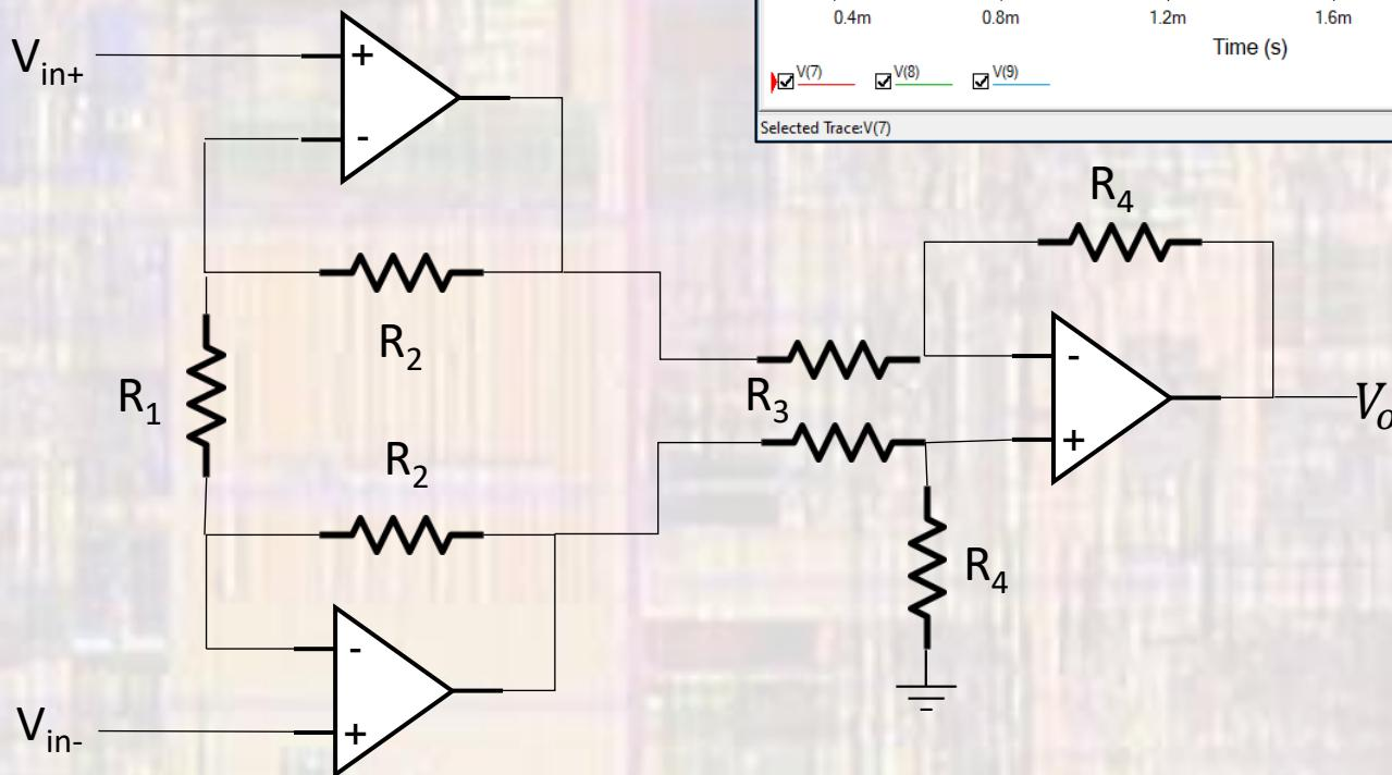
$$V_o = \frac{R_4}{R_3} \left( 1 + \frac{2R_2}{R_1} \right) (V_{in+} - V_{in-})$$
