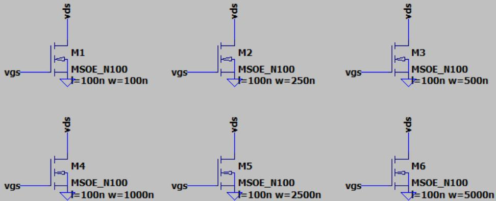
plotting  $I_d$  vs  $V_{gs}$  for 7 values of  $V_{ds}$
